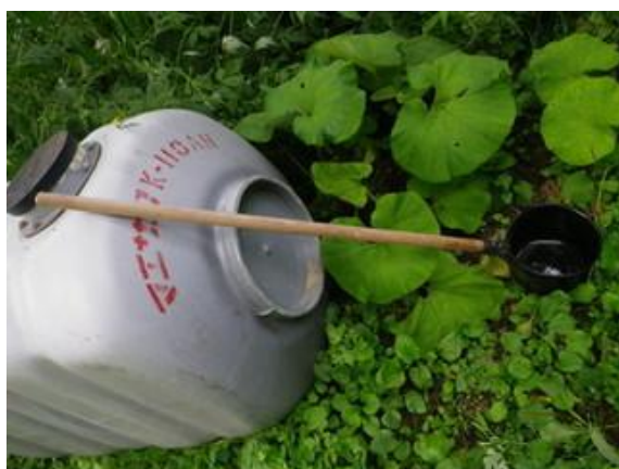
(写真5 2) ヒュッテの尿一時貯留用タンク
