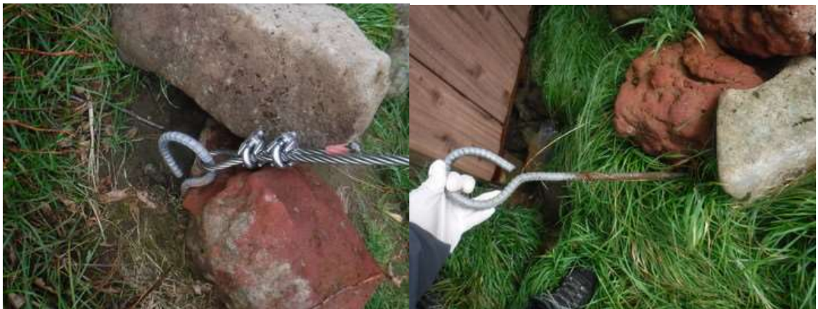
ブースの固定に使われる鉄杭丸形は、支持力が弱く簡単に抜けてしまいます。スノーバーのようなアンカーを使用したほうが強固に固定することができるようになります。
