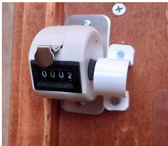
リセット操作防止カバーを設置(6月26日)
